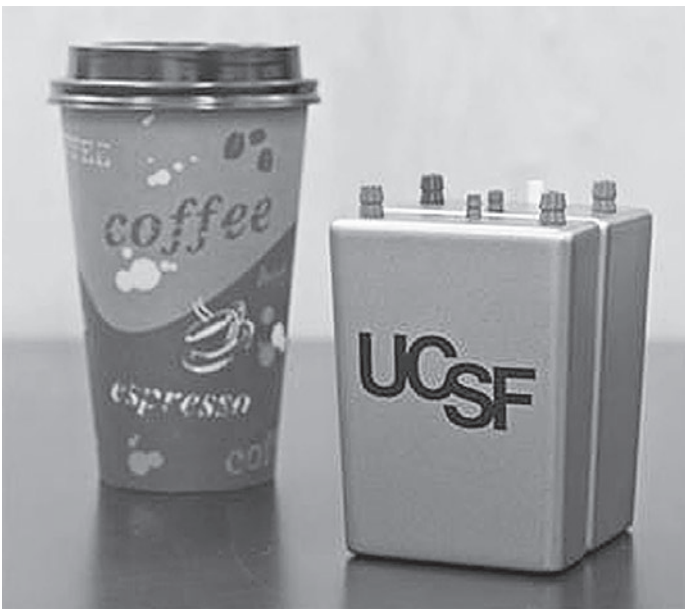
サンフランシスコ大学で試作された透析器
